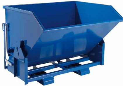
• 7074 Výklopný kontajner Objem: 1000 l Rozmery: 1650 x 1320 x 1080 mm Materiál: oceľ Povrchová úprava: prášková farba
